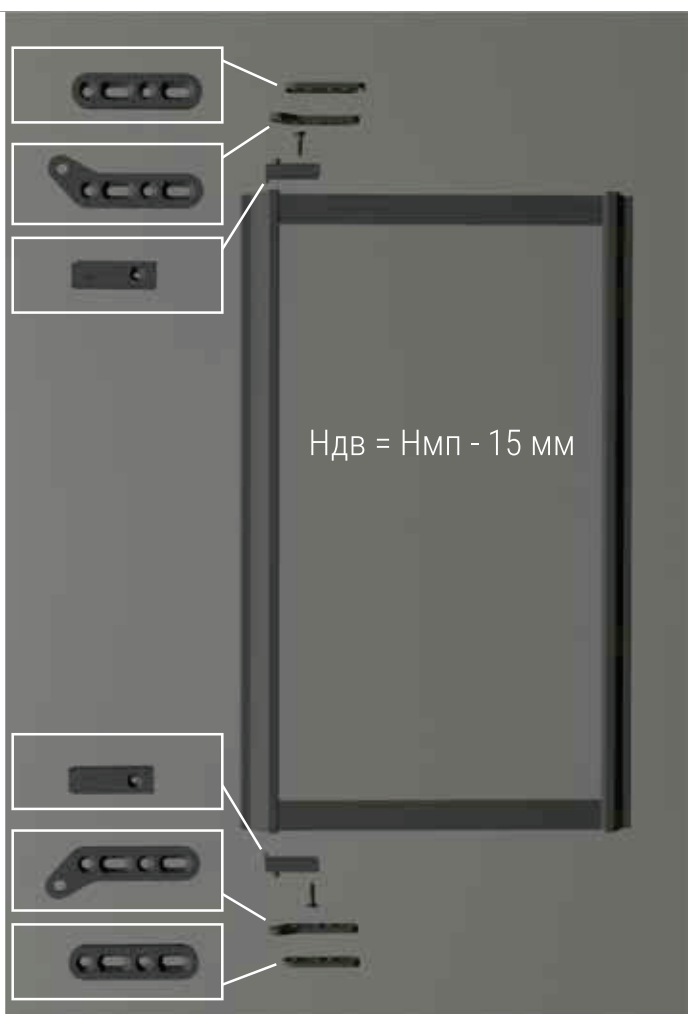
Расположение элементов при использовании KR08 и KR08 верхний горизонтальный профиль
