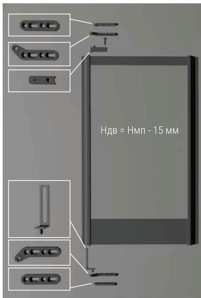
Расположение элементов при использовании KR08 верхний и KR07 нижний горизонтальный профиль
