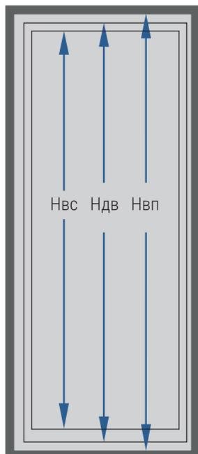
$H_{дв} = H_{вп} - 40\text{мм}$
